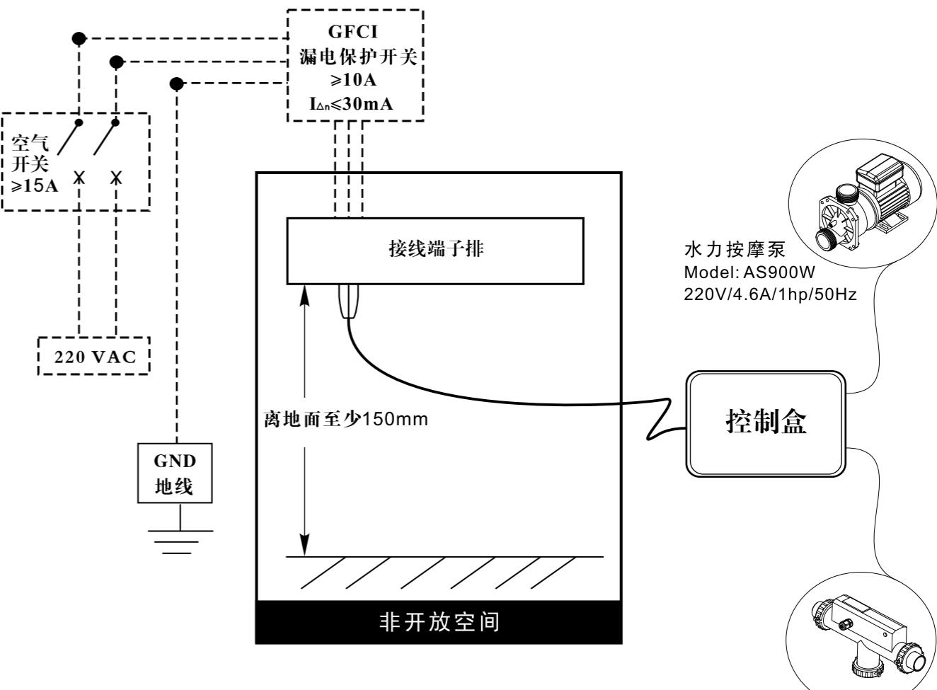
1. 用户提供与电气铭牌相匹配的电压和频率，不适当的电压和频率可能会引起火灾和马达的严重损害；
