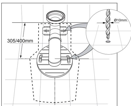
按照图示标注尺寸, 用 $\text{Ø}10\text{mm}$ 的钻头在地面标注位置打安装孔, 并预埋膨胀螺栓(以实际产品为准, 图片尺寸仅供参考)。
